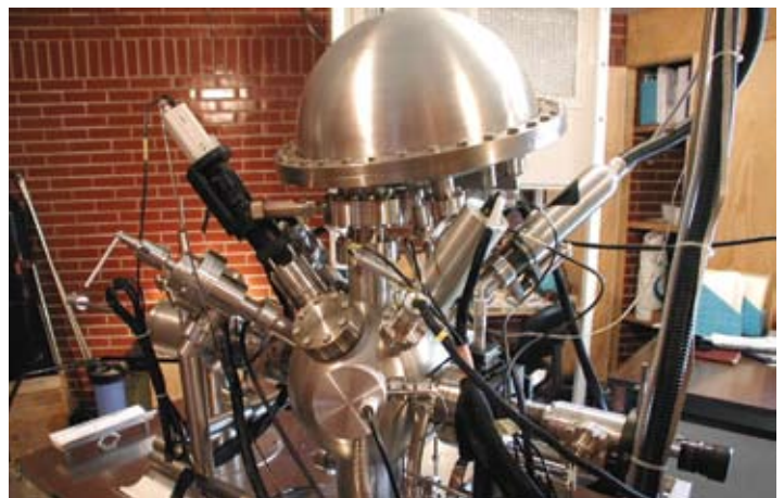
Cámara de pruebas mecánicas para películas delgadas
