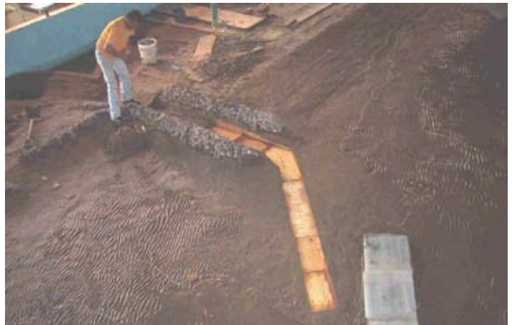
Modelo de fondo móvil para estudio de transporte de sedimentos
